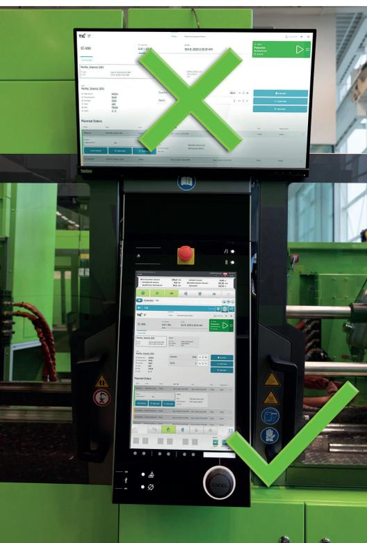
**Bild 1.** Zusätzliche Bildschirme werden überflüssig, webbasierte Dashboards können direkt auf der CC300 angezeigt werden. © Engel
